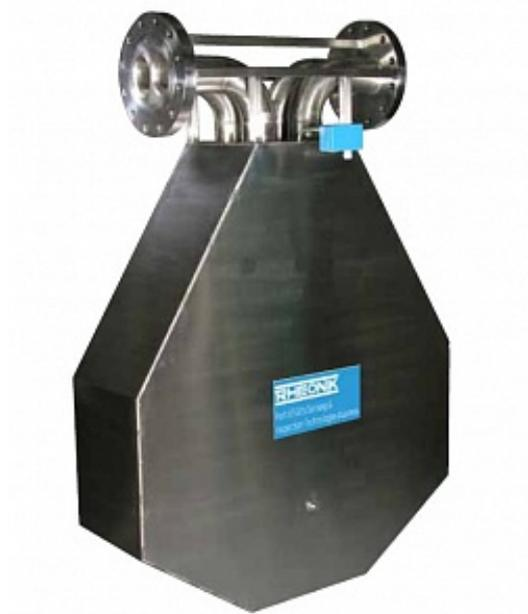
Омега-форма трубы обеспечивает крутильно-колебательное движение, а не изгибное, как другие кориолисовы расходомеры. Уникальное механическое устройство расходомера с Омега-формой трубы, благодаря большей толщине стенок, обеспечивает более высокое давление, повышает устойчивость к трению и износостойкость, а также позволяет избежать необходимости дополнительных мер по сдерживанию давления, которые необходимы при использовании других кориолисовых расходомеров.
